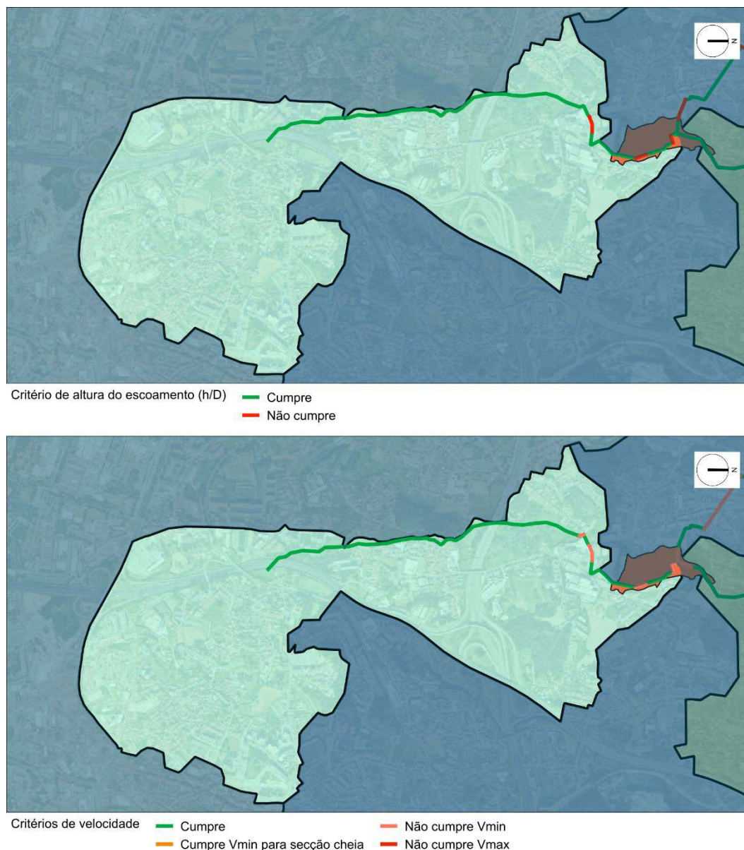
Figura 5.19 – Resultados da avaliação do desempenho hidráulico do emissário EM05 – Boi Morto.
