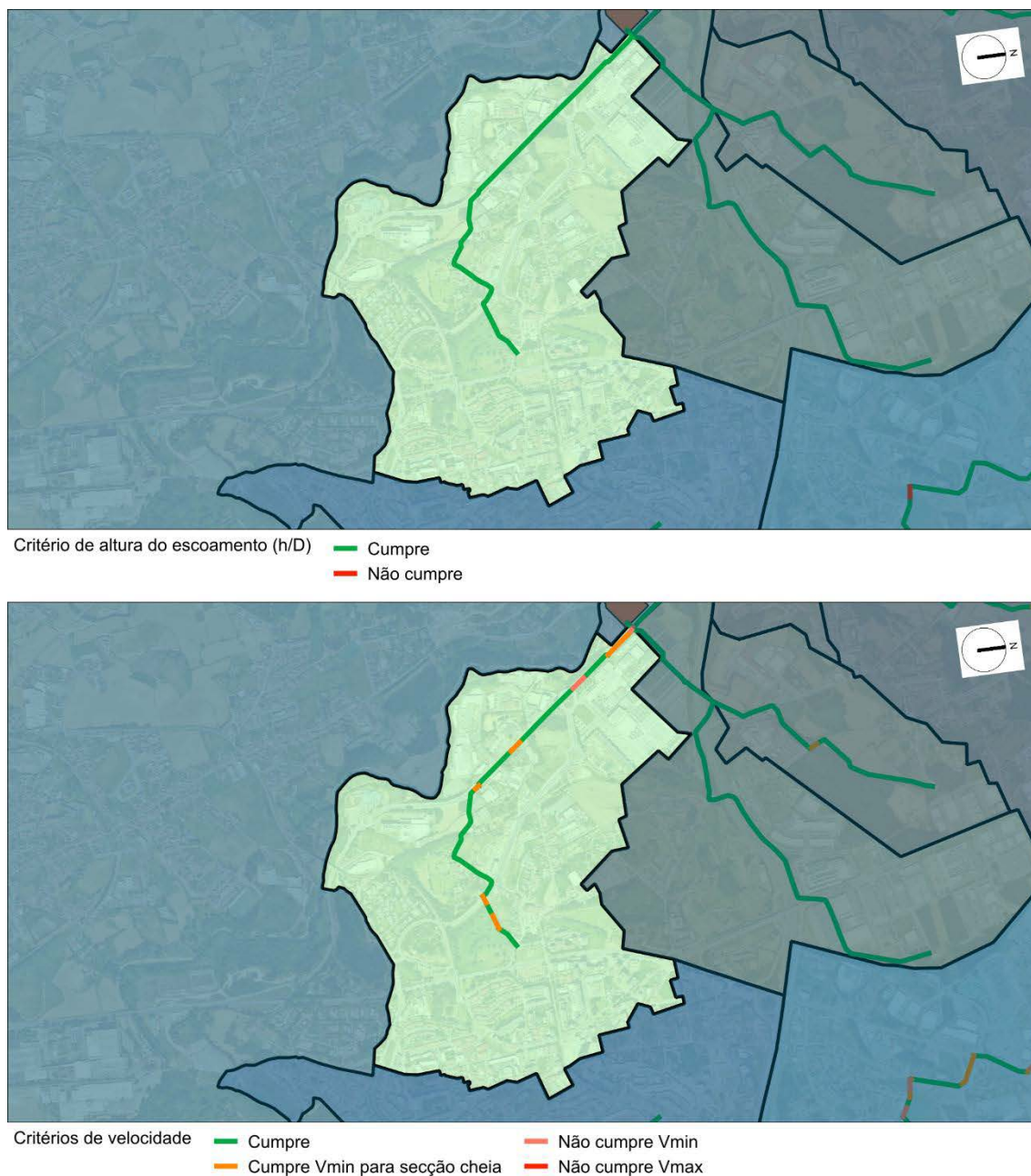
Figura 5.9 – Resultados da avaliação do desempenho hidráulico do emissário EM06 – Maia (Poente).
