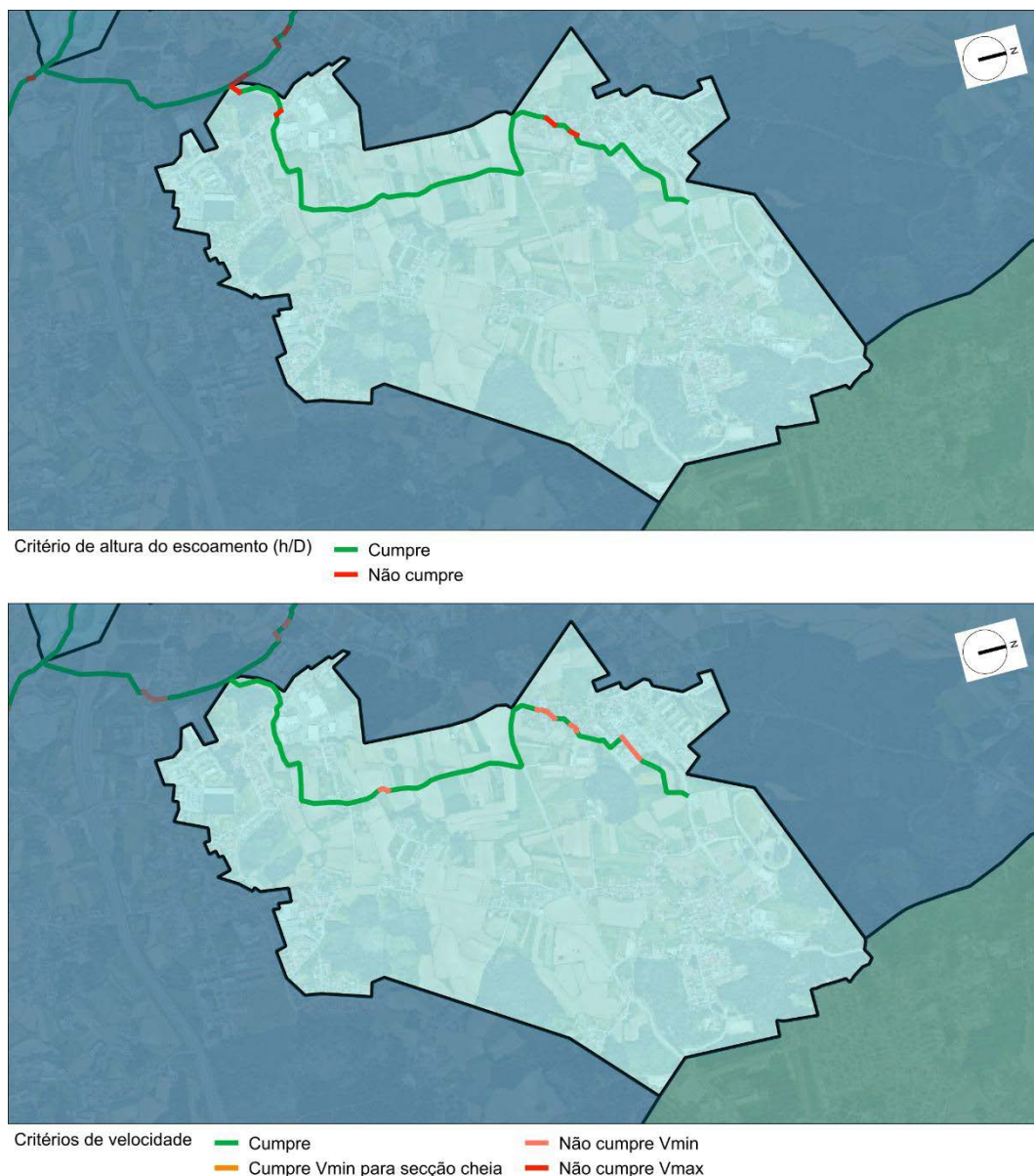
Figura 5.18 – Resultados da avaliação do desempenho hidráulico do emissário EM04 – Silva Escura.
