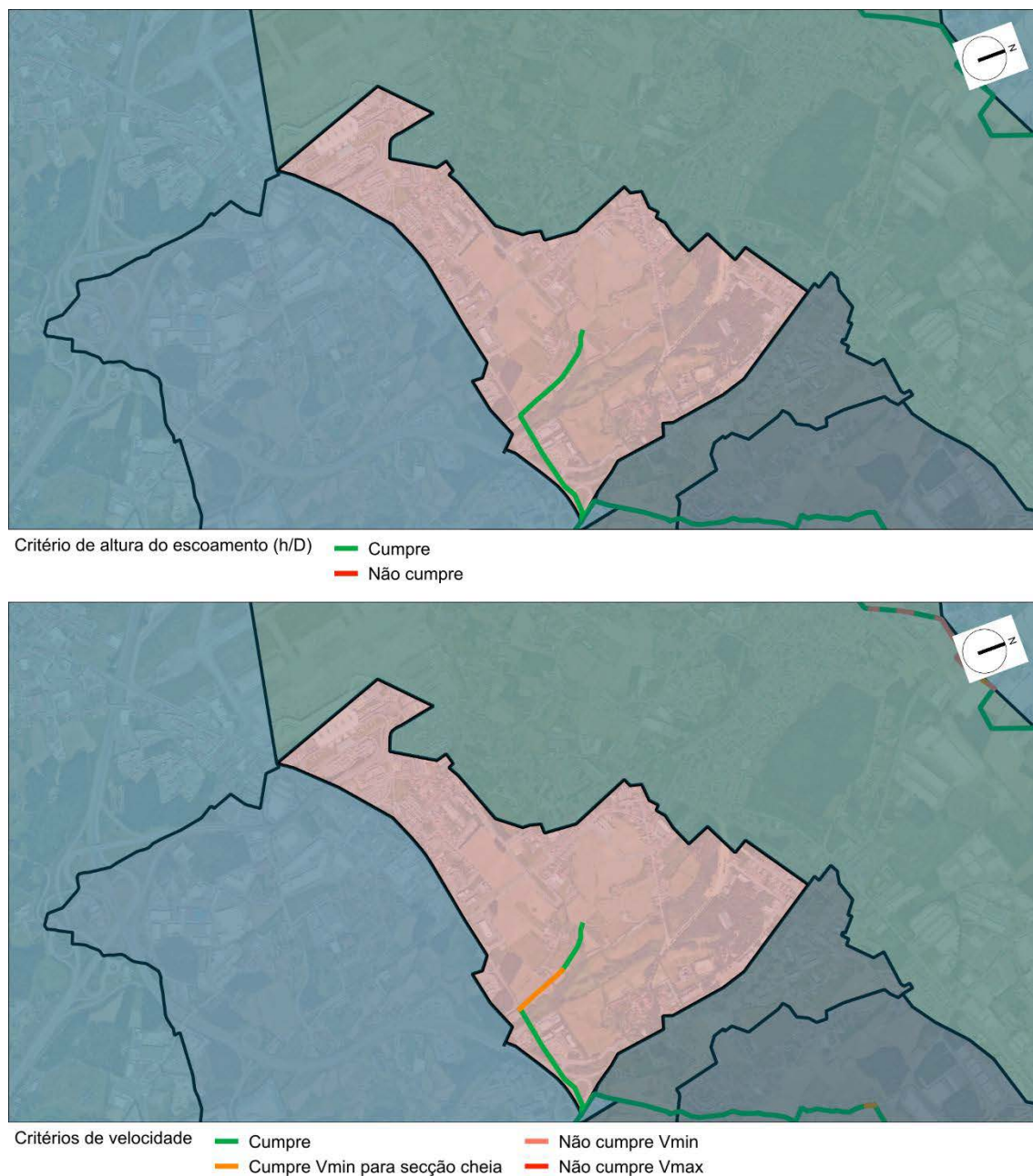
Figura 5.14 – Resultados da avaliação do desempenho hidráulico do emissário EM14 – Secundário de Matos.
