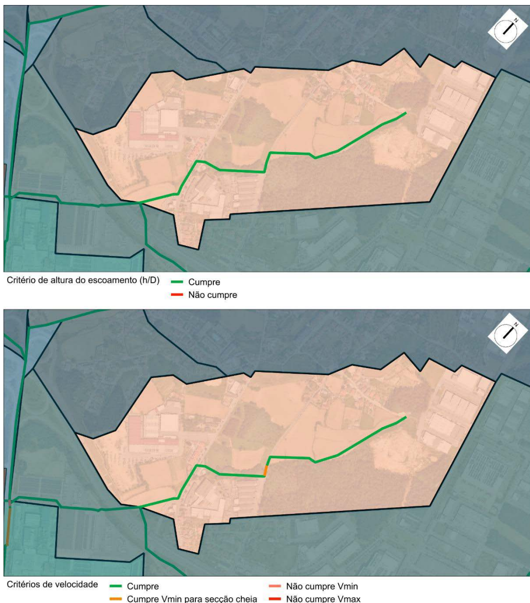
Figura 5.11 – Resultados da avaliação do desempenho hidráulico do emissário EM11 – Poente ZI.
