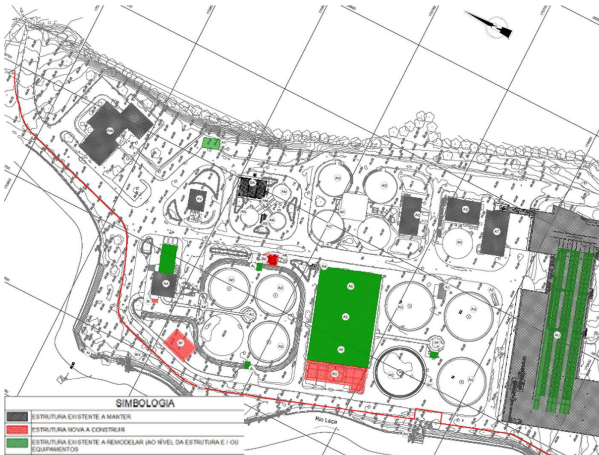
Figura 6.15 - Principais intervenções propostas para a ETAR de Parada (COBA, 2024b)
