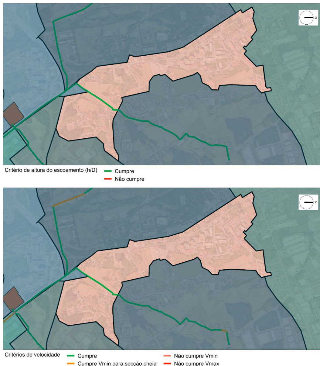
Figura 5.12 – Resultados da avaliação do desempenho hidráulico do emissário EM12 – Guarda.
